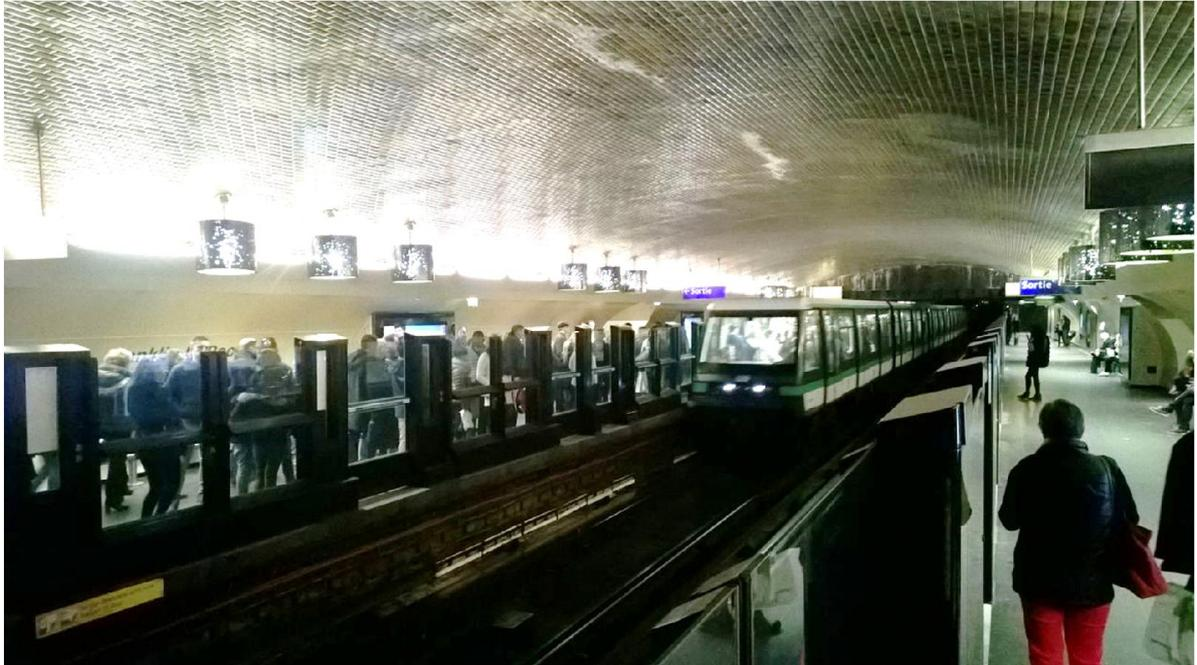
*Foto 2 - Metro linea 1, stazione F.D. Roosevelt con le basse porte di banchina ed un treno tipo MP05 automatico in arrivo - dicembre 2016*
