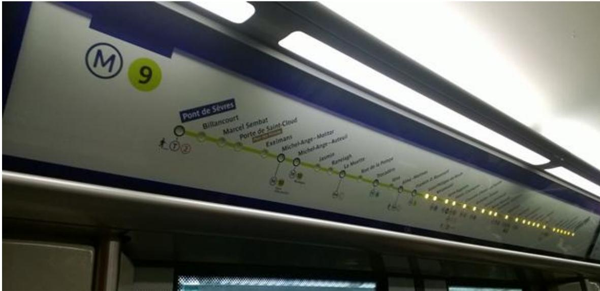
Foto 4 - Particolare sui nuovi treni tipo MF01, l'indicazione luminosa delle fermate già passate ( luci spente ) e quelle prossime ( luci accese ), qui sulla linea 9 - dicembre 2016
