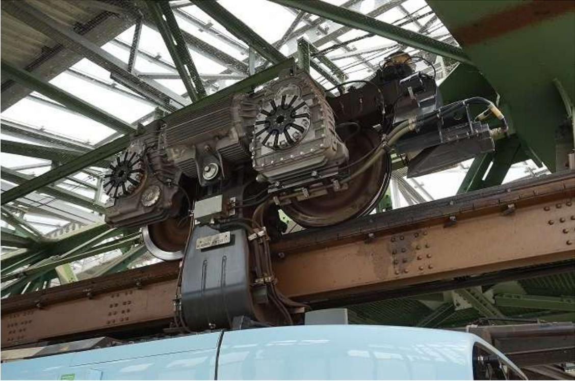
*Foto 18 - Particolare del "carrello di testa" di un nuovo convoglio Kiepe*
