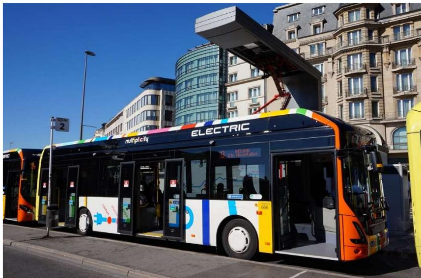
Foto 21 - Lo stesso Volvo 7900 elettrico della linea 13, lato porte, in carica al capolinea di place de la Gare
