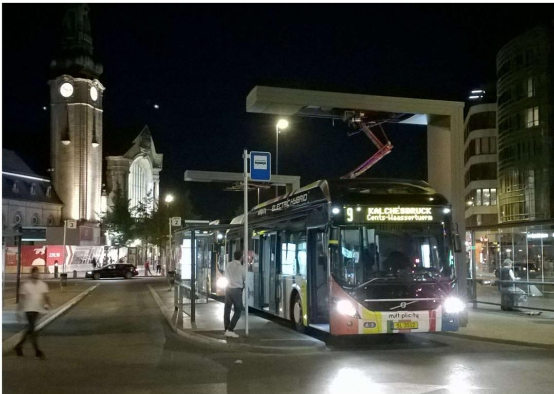
*Foto 18 - Ricarica "notturna" per questo Volvo 7900 ibrido-elettrico della linea 9, al capolinea-stazione di ricarica di place de la Gare. L' edificio con torre a sinistra è la stazione ferroviaria di Lussemburgo*
