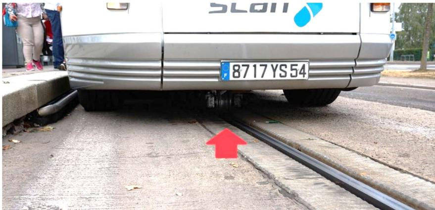
*Foto 57 - Il primo ruotino guida di un GLT/TVR ( ce ne sono due per ogni asse, uno davanti ed uno dietro )*
