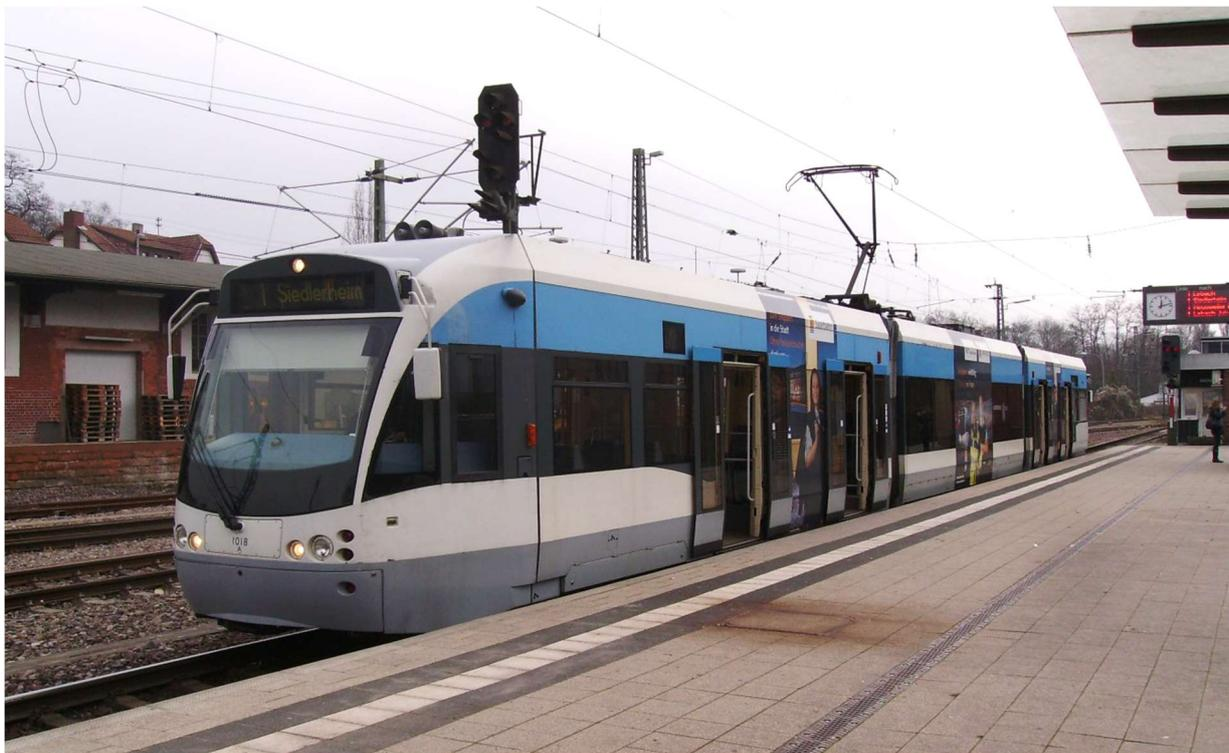
*Foto 72 - Un altro convoglio tram-treno di Saarbrücken al capolinea sud del servizio urbano a Brebach, già sotto la catenaria ferroviaria alimentata a 15 kV*
