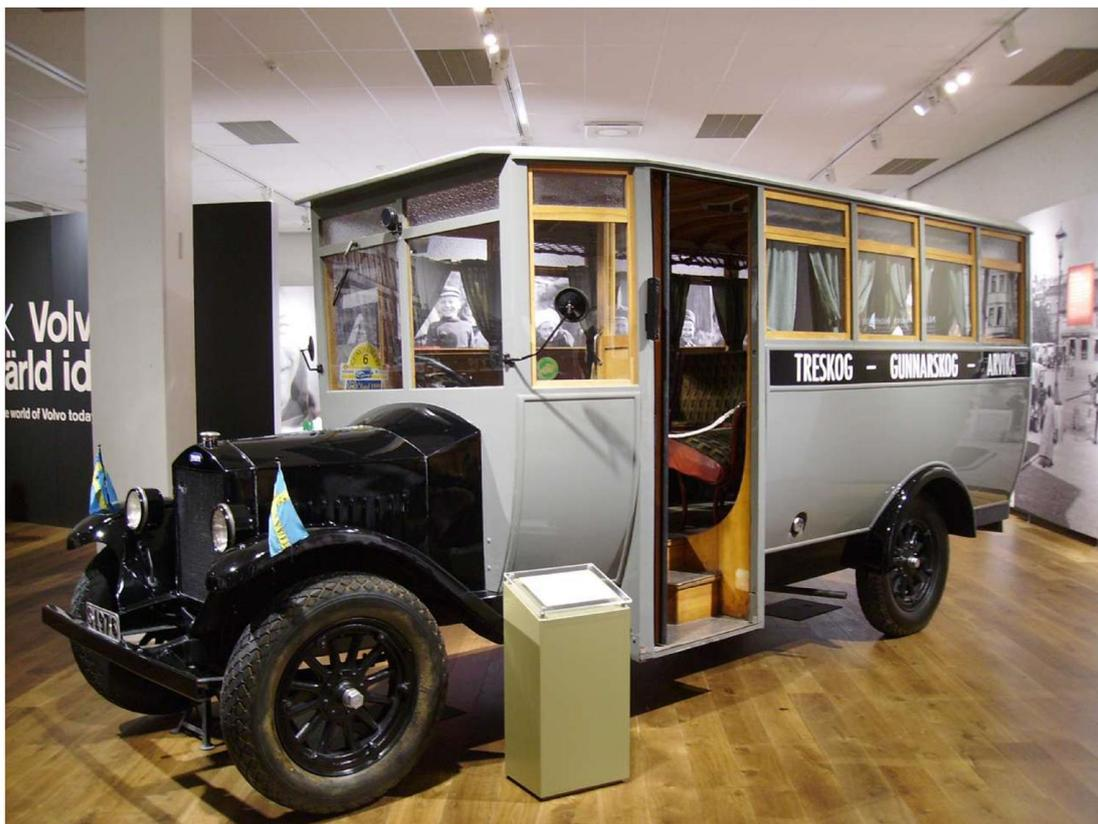
Foto 68 - Autobus modello LV4 del 1928, con telaio e carrozzeria in legno
