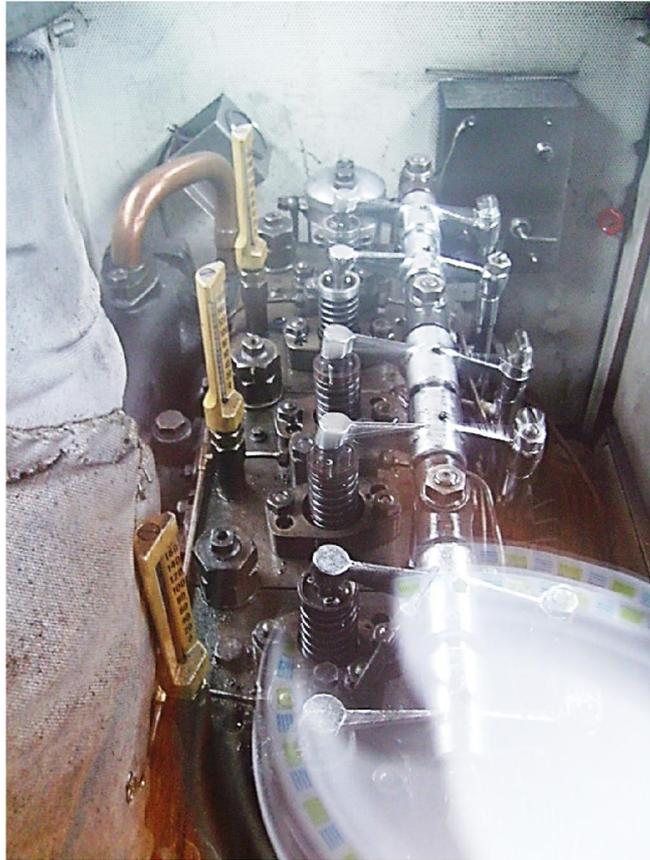
*Foto 22 - Il motore diesel "in vetrina" del battello Aue*
