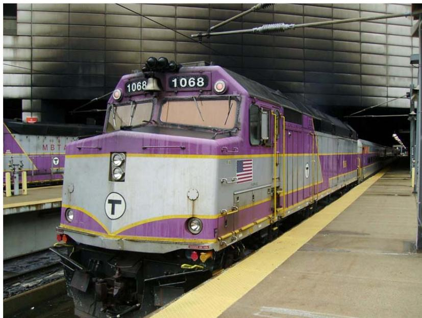
*Foto 8 - Classico "musone" F40PH-2C di MBTA in testa ad un commuter train per Providence in stazione a Boston South*
